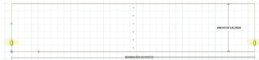
Figura 1. Trama de cálculo 1 x 6 para iluminancia a 1.5m.
